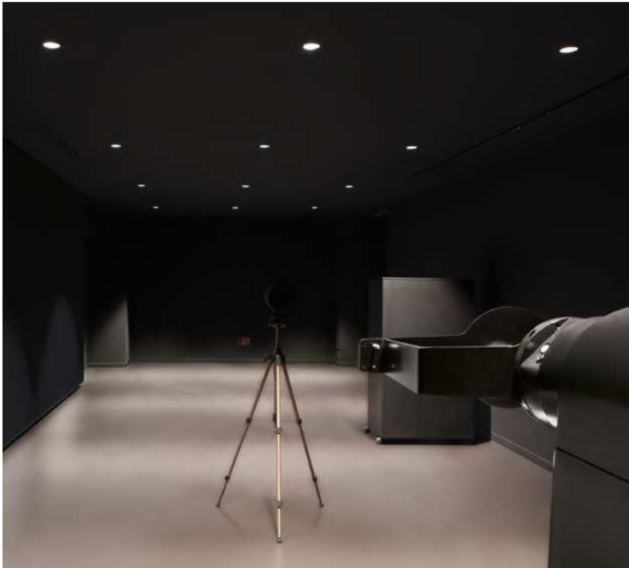
Arkoslight cuenta con su propio laboratorio para ensayos fotométricos. Este permite la total autonomía de Arkoslight en el estudio de las propiedades luminotécnicas de sus productos, gracias a la alta precisión de su gonioespectrómetro de última generación.
