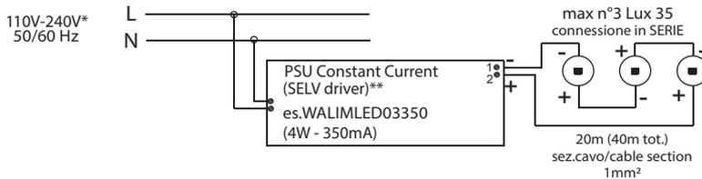
\*Verificare la tensione di ingresso supportata dagli alimentatori / Verify the input tension supported from drivers
