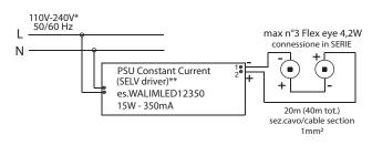
Verificare la tensione di ingresso supportata dagli alimentatori / Verify the input tension supported from drivers
