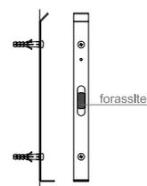
Non prevede particolari predisposizioni (solo foratura per tasselli e fissaggio con viti)
