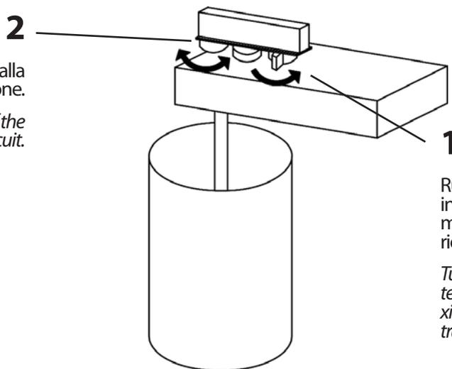
Ruotare la leva secondo la direzione indicata per procedere al fissaggio meccanico dell'apparecchio al binario elettrificato.
